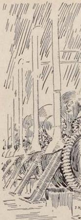
Die Tabakblätter werden durch das blitzschnell auf- und niederschwingende Messer in haardünne Fasern zerlegt.
